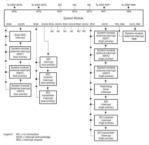
Figure 2–15. System-Module Interrupt Structure
